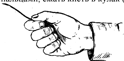
Рис. 6. Как берется шнур для вращения прашевого термометра
