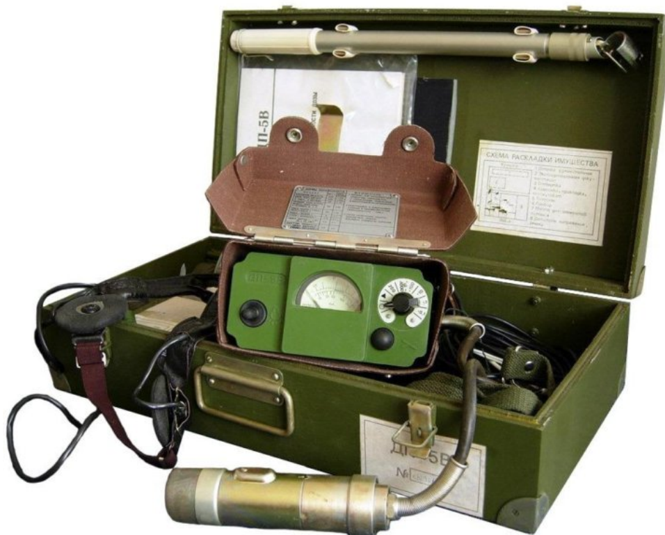
Рис. 1 Измеритель мощности дозы (рентгенметр), ДП-5В
