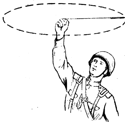
Рис. 7. Вращение пращевго термометра
