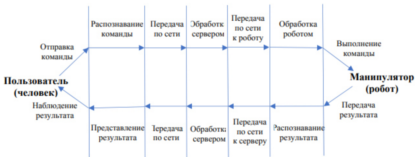
Рисунок 24 – Передача команд от пользователя к манипулятору и наблюдение пользователем результата выполнения команды манипулятором
